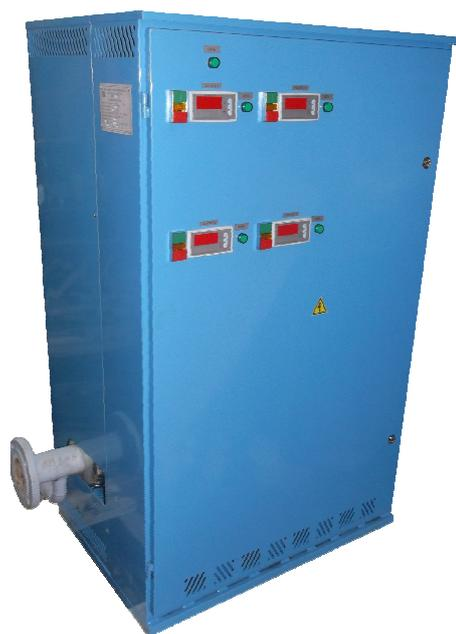
Электрический Пароперегреватель серии ЭПГ-П производства ООО НПП “Теплотехника” применяется для получения перегретого пара повышенной температуры до 250 градусов (более по заказу) и номинального давления 0,8 МПа. Перегреватель также может применяться для нагрева масла, воздуха и т.д.
